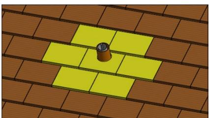
7. Recouvrir l'ensemble plot support avec la cloche. →
