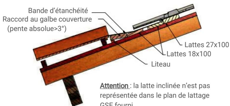
Un lattage type « chanlatté » est disposé pour rattraper le galbe de la tuile et offrir un support plat à la bande d'étanchéité.
