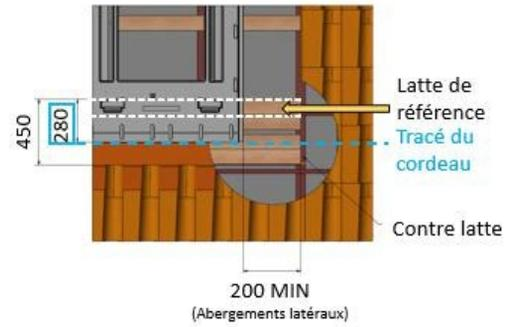
2 Emboîter les plaques de droite à gauche avec chevauchement des ondes (Possibilité de gauche à droite – vérifier l’emboîtement).
