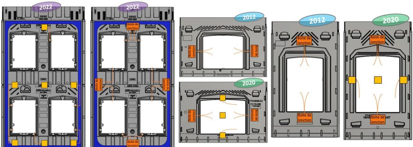
Dans le cas d'utilisation de micro-onduleurs, fixer ceux-ci sur une latte au niveau du trou central de la plaque GSE.
