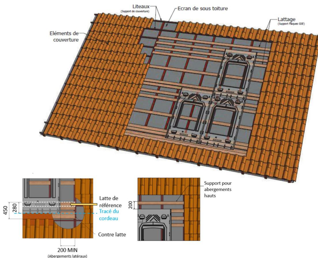
**ATTENTION : LE POSITIONNEMENT DES ETRIERES ET DE LEURS LATTES SUPPORT DEVRA AVANT TOUT SE CONFORMER AUX PRECONISATIONS DU FABRICANT DE MODULES.**
