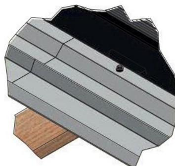
2. Visser une vis CAPINOX à l'endroit de l'ancien perçage en ayant préalablement placé une nouvelle cale en polypropylène sous l'onde, s'il s'agit du bord de champ.
