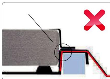
**ATTENTION: DANS LES 2 CAS, LA BANDE SOUPLE PRISE EN ETAU ENTRE L'ABERGEMENT ET L'ONDE DE LA PLAQUE GSE DEVRA ETRE POSITIONNEE SUR LE DESSUS DE L'ONDE POUR EVITER UN RISQUE DE DECHIREMENT.**
