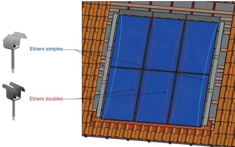
**NE PAS UTILISER DE VISSEUSE A CHOC POUR LA FIXATION DES ETRIERS. IL FAUT IMPERATIVEMENT UTILISER UNE VISSEUSE NORMALE POUR LE BON MAINTIEN DES ETRIERS AU FIL DU TEMPS.**
