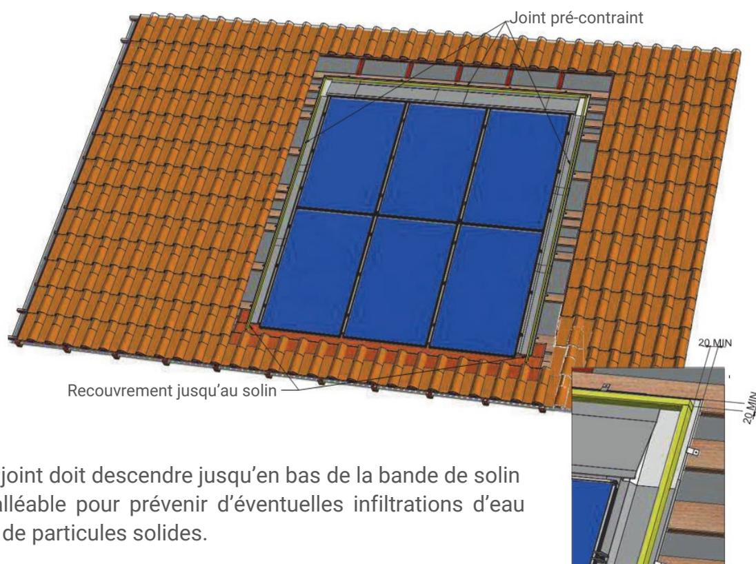
Le joint doit descendre jusqu'en bas de la bande de solin malléable pour prévenir d'éventuelles infiltrations d'eau ou de particules solides.
