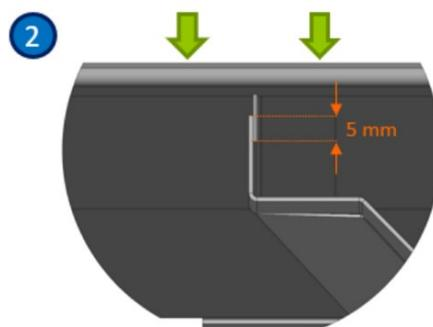
Régler la hauteur de l'abergement d'angle en superposant les 2 parois
