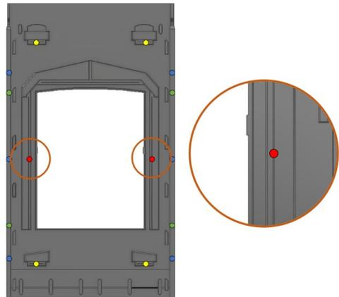
**ATTENTION : LORS DE LA POSE DES RANGS SUIVANTS, AJUSTER LE RECOUVREMENT D'UN RANG SUR L'AUTRE AVEC LA GRADUATION EN FONCTION DE LA LONGUEUR DU MODULE (CF DISPOSITION LATTAGE)**
