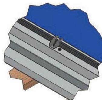
4. Placer le module et fixer les nouveaux ensembles (étrier + joint EPDM + vis CAPINOX).
