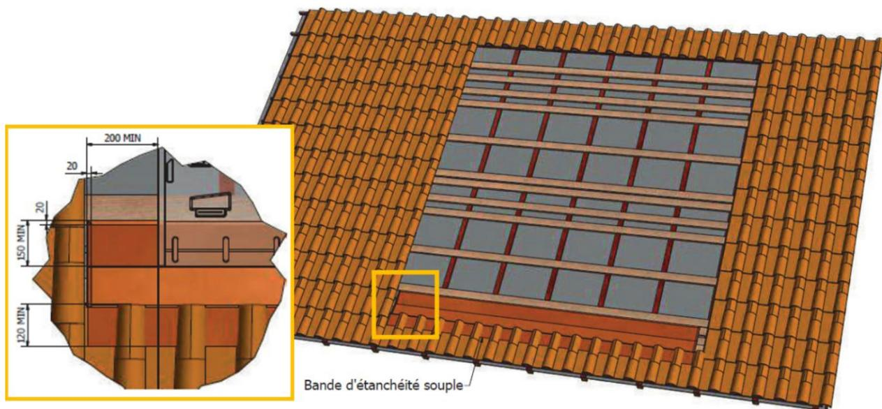
La bande d'étanchéité est disposée de manière à faire la jonction avec la couverture en partie basse (Champ PV en milieu de toiture).
