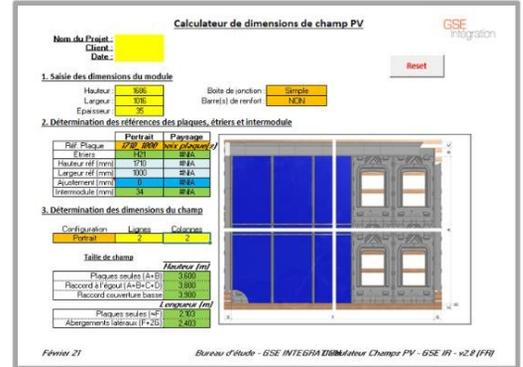
La taille du champ se calcule à partir de la référence de plaque GSE utilisée (se référer aux sections 1.4, 1.5 et 1.6 pour déterminer la plaque GSE compatible avec le module) :
