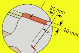
Lors de l'application de la bande d'étanchéité sur des tuiles à relief, veiller à bien la maroufler de manière à épouser correctement la forme de la tuile. Effectuer une pince de 20 mm en partie supérieure et latérales pour prévenir d'éventuelles remontées d'eau.
