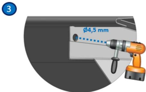
Une fois la hauteur réglée, percer les 2 parois superposées avec une mèche de 4,5mm
