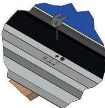
3. Effectuer un nouveau pré-perçement de 10mm décalé de 25 mm au-dessus de l'ancienne position.
