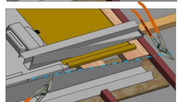
**Figure 38 – Pose des abergements latéraux et d'angles supérieurs (kit TN-1)**
