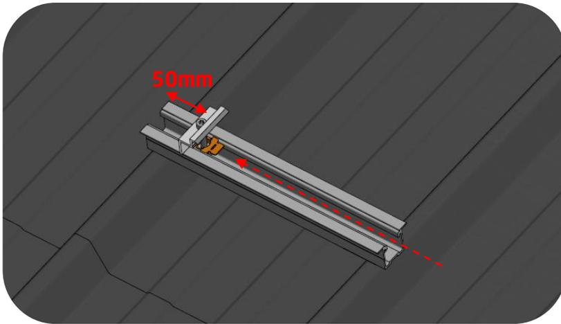
**NB :** Laisser un débord de rail de 50mm entre le côté de l'étrier et l'extrémité du rail
