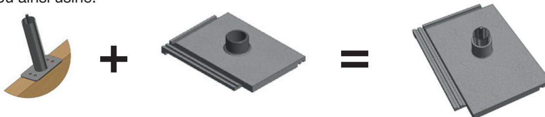
**D-** Placer la cloche de recouvrement sur le support de fixation en prenant soin de vérifier que la cloche vienne se poser sur le plot support afin de garantir une bonne étanchéité.
