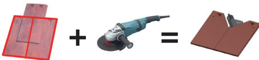
**C-** Découper la plaque à douille à la taille de la tuile plate en laissant bien dépasser les tétons.
