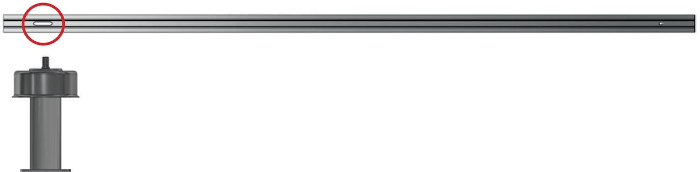
**B-** Placer ensuite le rail au dessus des plots suivants et percer un trou de Ø8mm dans le rail au niveau de la tige de chacun des plots supports du guide de perçage fourni.
