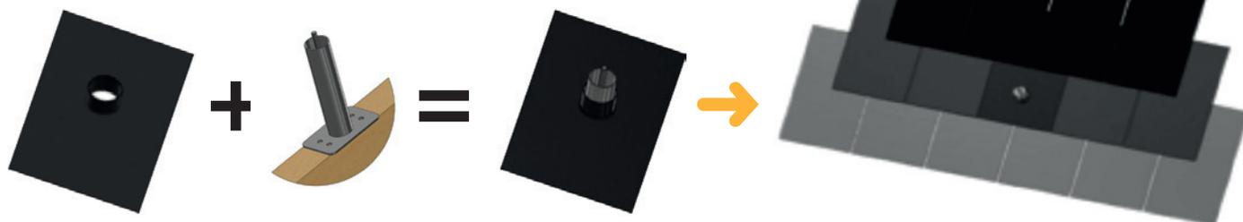
E- Placer la cloche de recouvrement sur le plot support en prenant soin de vérifier que le tube entre dans l'insert.
