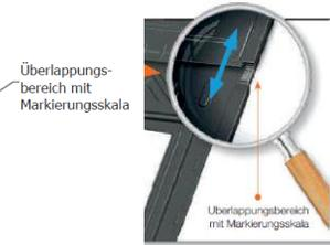
Passen Sie die Markierungsskala zwischen den Reihen der Basisplatten an die Länge des Solarpanels an
