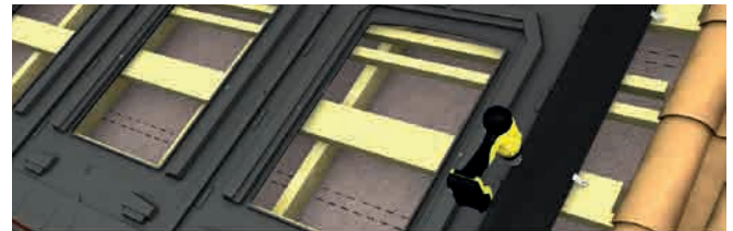
Vorbohren der Verblechung, GSE-Wannen-Falz und Verstärkungskeil für einschenklige Klemmen
