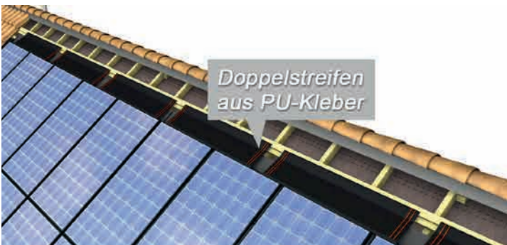
Einbau der oberen Verblechung
