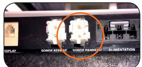
Anschluss der Modultemperaturfühler
